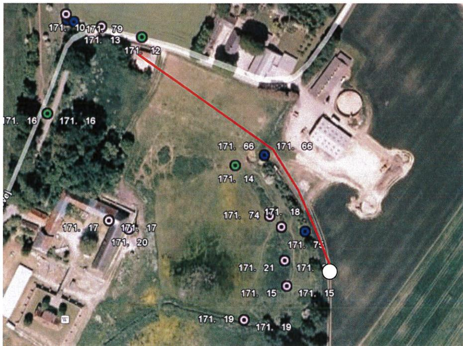
Figur 5.1 Omlægning af råvandsledning og forslag til evt. ny boring
